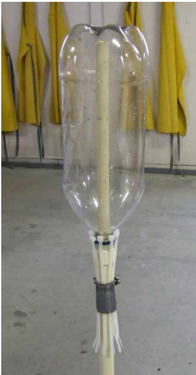
Figure 24-A Ligatures de câble tenant la bouteille de boisson gazeuse
