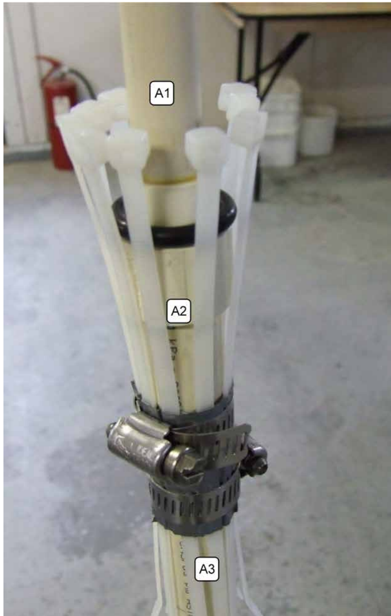
Figure 25-A Colliers de serrage autour des ligatures de câble à A3
