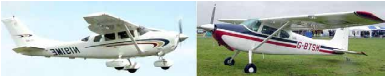
Figure 3 Roue de train d'atterrissage avant vs roulette de queue
