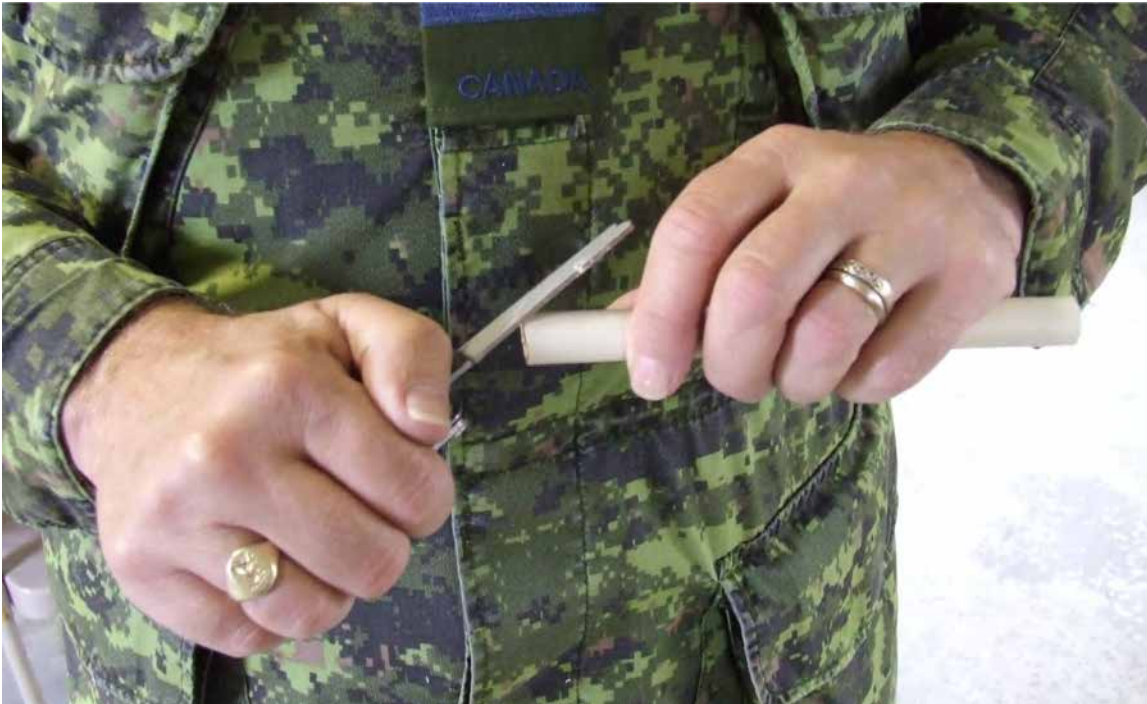
Figure 5-A Ébavurer l'extrémité d'un tube au moyen d'une lime.
