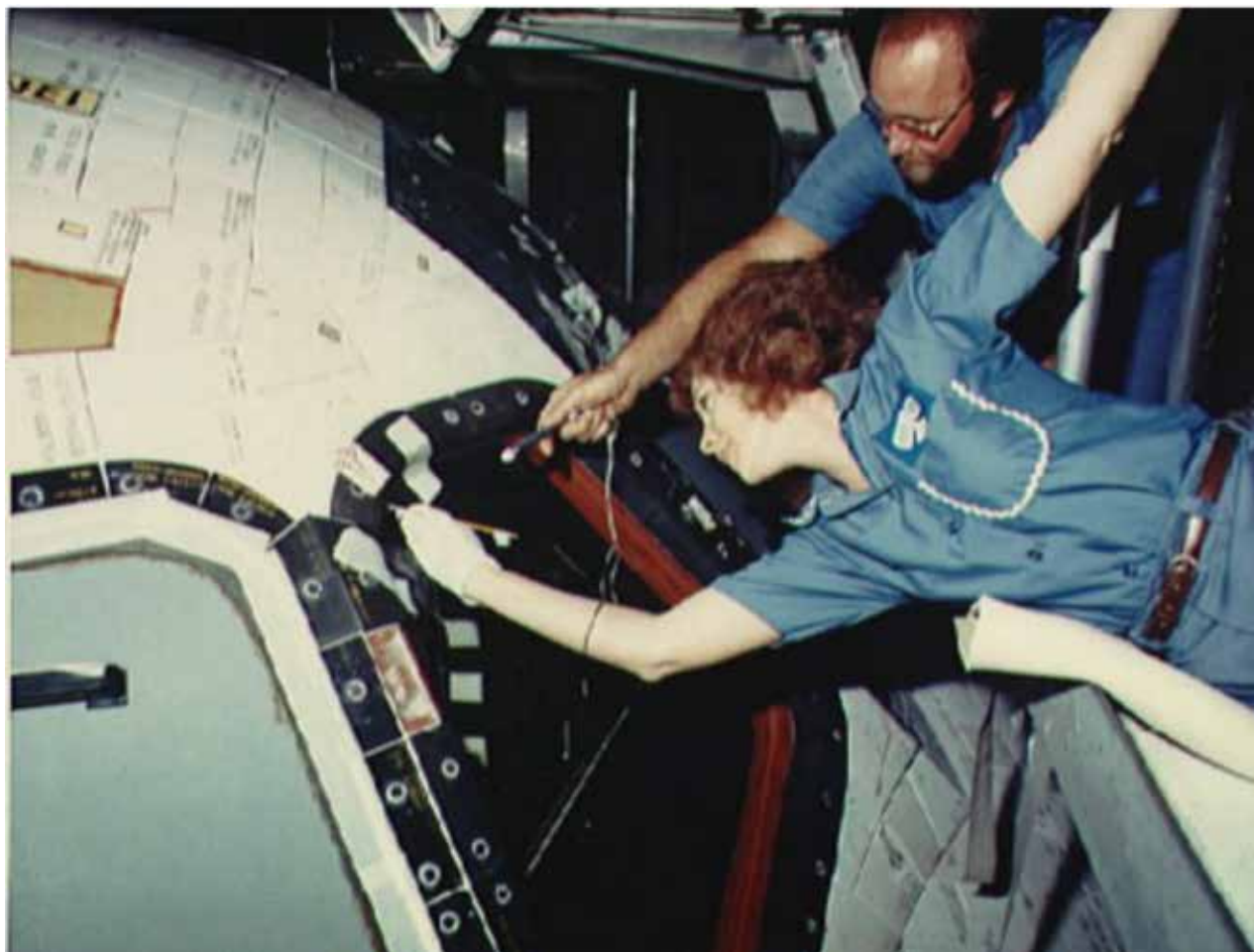
Figure 17O-4 Réparation du système de protection thermique de la navette Columbia
