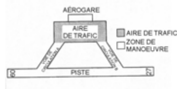
Figure 14-1-1 Zones de mouvement de l'aéroport
