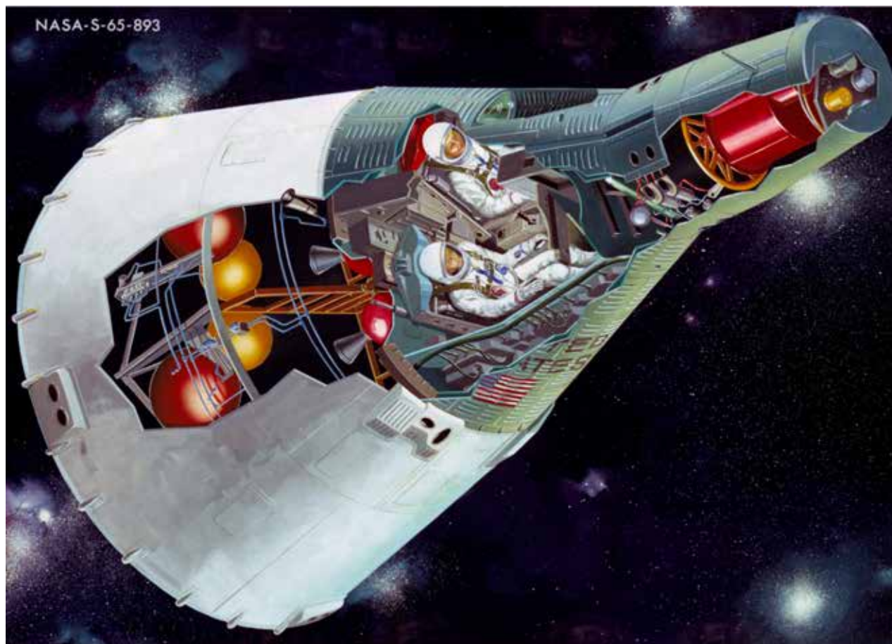
Figure 15J-2 Détail de coupe de la capsule Gemini
